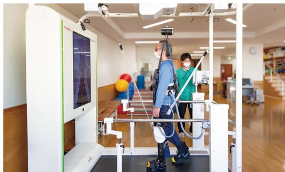
近年、リハビリ医療にロボットの開発が盛んになっています。当院では平成28年から「Welwalk WW-1000」(藤田保健衛生大学とトヨタ自動車株式会社の共同開発)を臨床研究の段階から導入しています。脳血管疾患の片麻痺患者を主対象とし、重度麻痺患者でも多歩数の歩行が可能となっています。超低速から歩行できるトレッドミル、転倒予防・懸垂免荷ハーネスで安全を確保して、下肢の支持性はロボット脚が補助し、振り出しも滑らかに膝を曲げながら補助をしてくれます。
